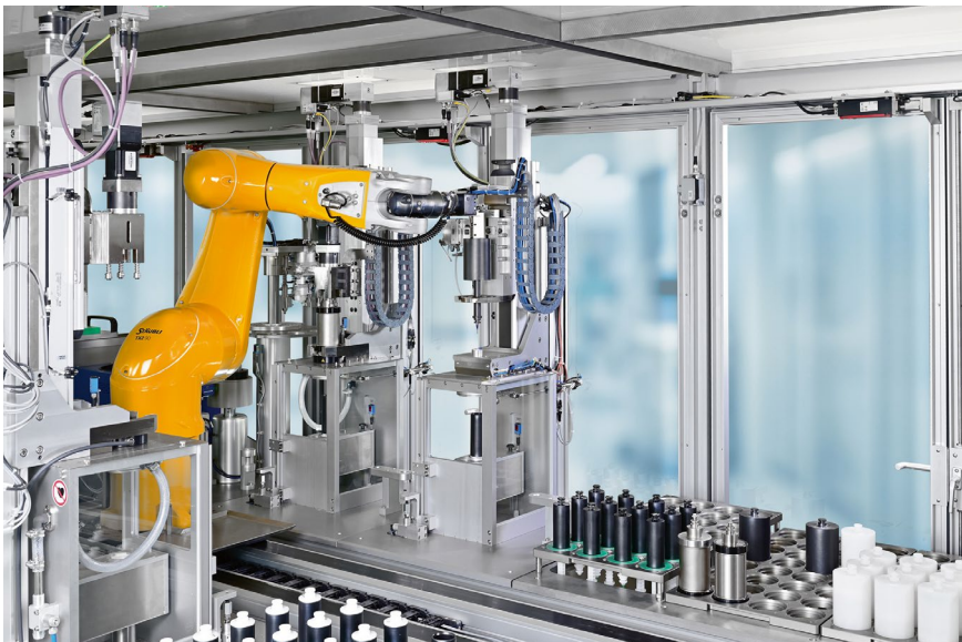
Bild 5 > Der Handlingroboter transportiert eine Rohstoffspritze.
