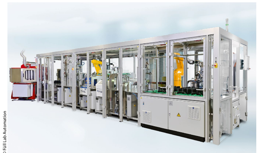
Bild 3 > Die zehn Meter lange und vier Meter breite Anlage umfasst 21 aktive Module.
