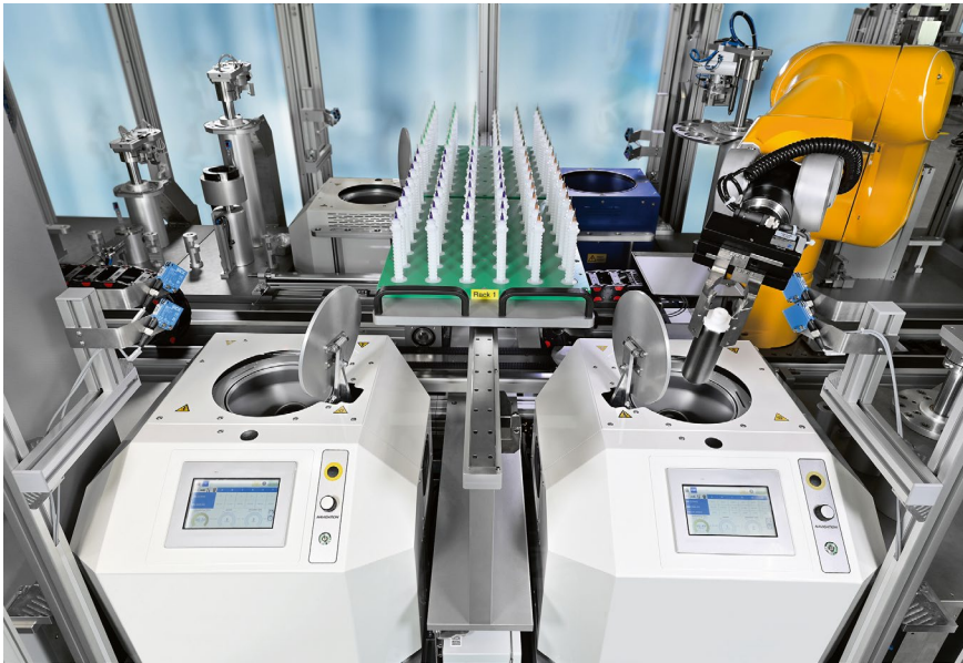
Bild 4 > Vakuummischer ermöglichen das präzise Anmischen und vollständige Entlüften hochviskoser Formulierungen auch in kleinen Mengen.
